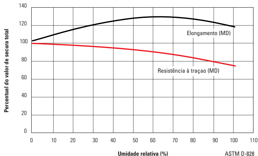
Figura 6 – EFEITO DA UMIDADE NAS PROPRIEDADES MECÂNICAS NOMEX® TIPO 410 - 0,25 MM (10 MIL. POLEG.)
